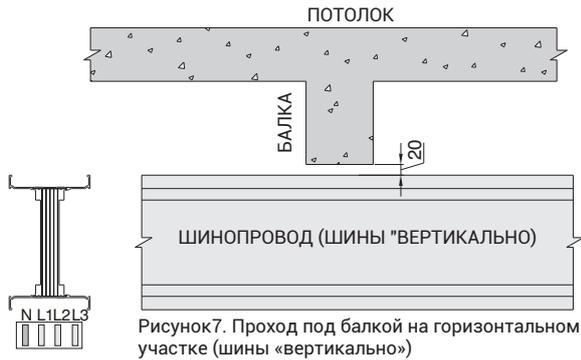
Рисунок 7. Проход под балкой на горизонтальном участке (шины «вертикально»)
